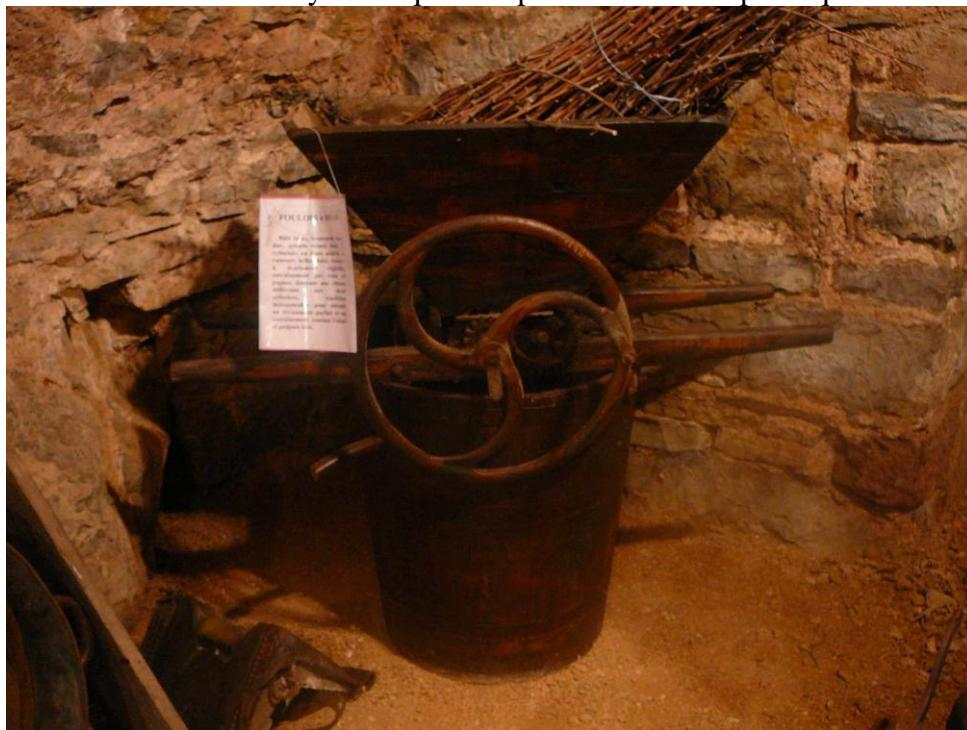
L'appareil était composé de 2 cylindres en fonte acierée et à rainures hélicoïdales, ressort à écartement réglable qui tournaient en sens inverse actionné par une manivelle à bras. Les cylindres écrasaient entre leurs cannelures les grains de raisins déversés dans une trémie.
